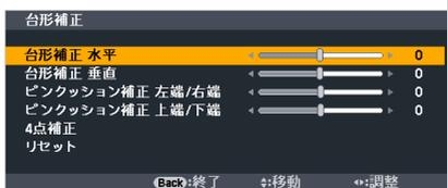
補正は、台形補正 水平と台形補正 垂直（同時調整可）、ピンクッション補正 左端 / 右端、ピンクッション補正 上端 / 下端、4点補正のいずれかの補正が選択できます。選択すると調整できない補正はグレイ表示になります。他の補正を行うときはリセット操作を行ってください。
